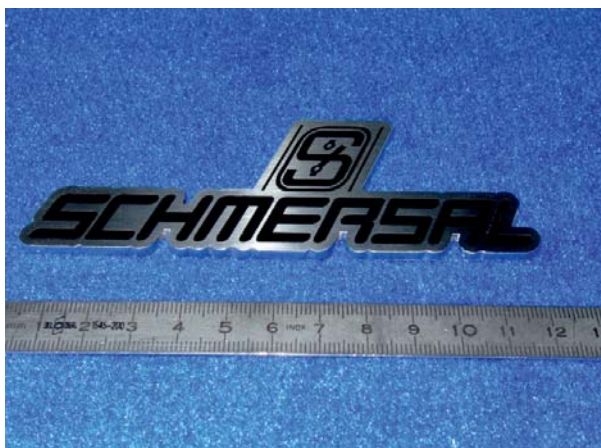
Schwarzätzung, Außenkontur gelasert
