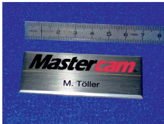
Angefastes Schild, Ätzung farbig ausgelegt
